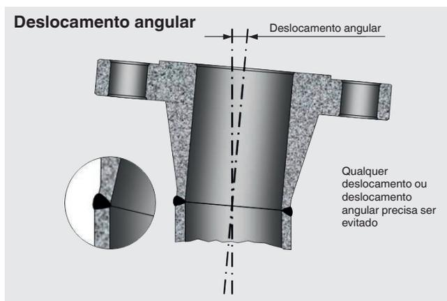
Se existem irregularidades de solda, o colar já usinado estará grande para a instalação - agora um ajuste com interferência é impossível e o poço de proteção dimensionado não pode ser usado.
