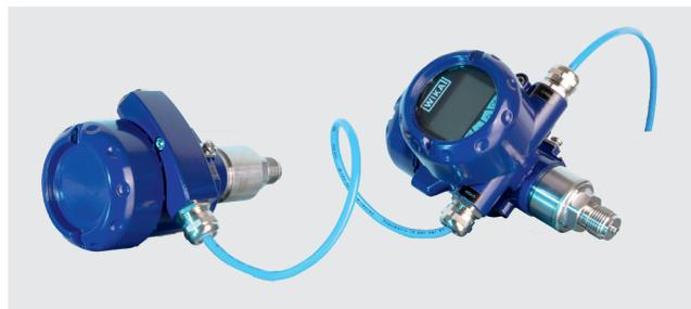
Измерительные преобразователи соединяются друг с другом с помощью внутренней шины (→ см. рисунок). Конфигурирование связки мастер-подчиненное устройство производится в мастер-устройстве. Таким образом, данный прибор берет на себя управление обоими чувствительными элементами. Выходным сигналом будет давление процесса, измеренное мастером и подчиненным устройством, а также перепад давления.
