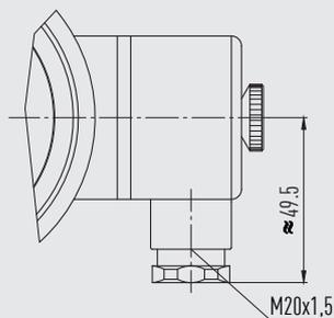
Используйте только кабель диаметром 7 ... 13 мм
