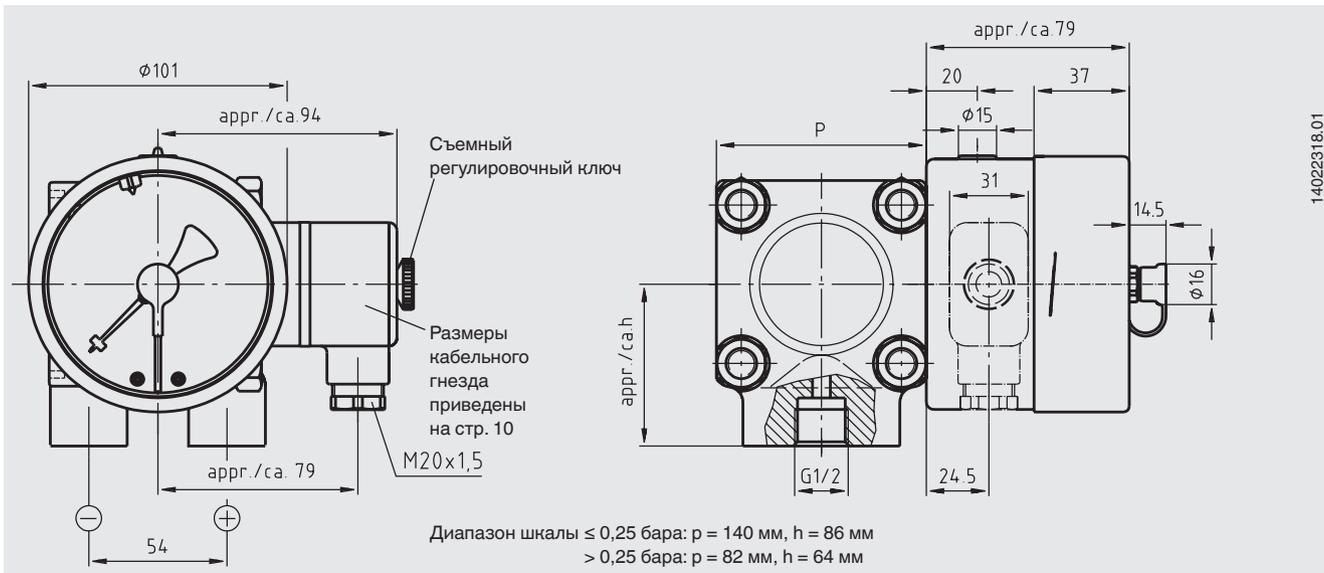
switchGAUGE, модель DPGS43HP.160 с электроконтактами модели 851.3
