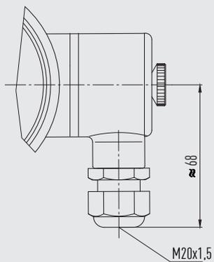
Используйте только кабель диаметром 5 ... 10 мм
