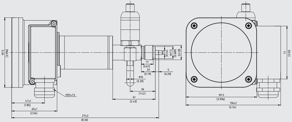
Modello GDM-RC-100-T con trasmettitore digitale collegato e attacco al processo verticale G ½ B
