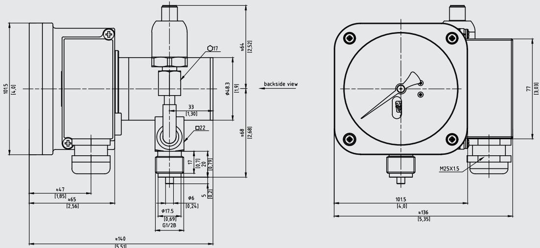
**Modello GDM-RC-100-T con trasmettitore integrato e attacco al processo posteriore DN 8**
