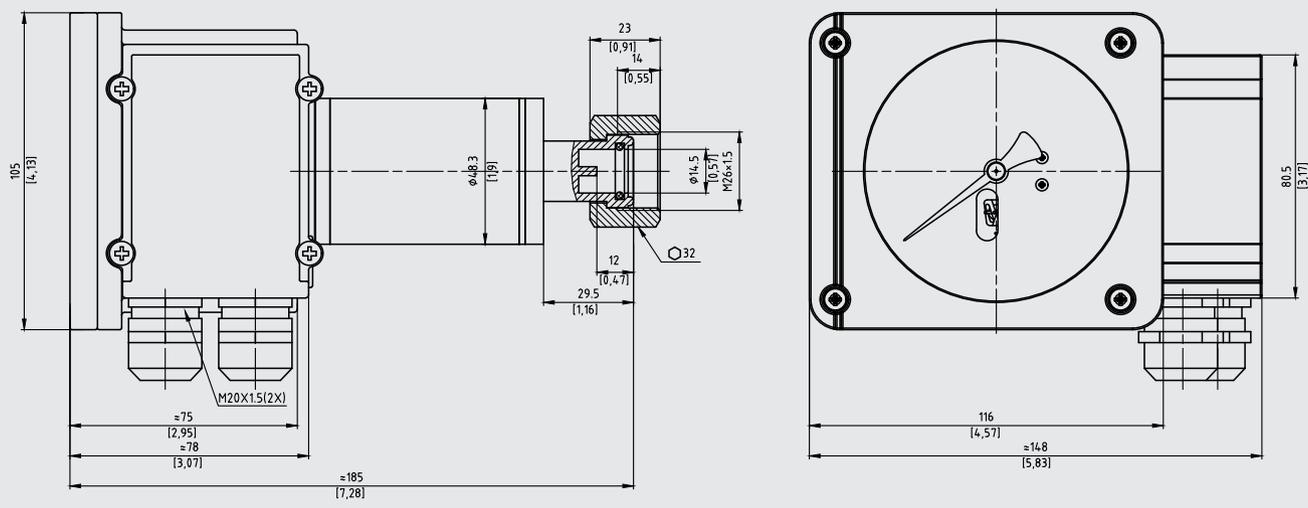
**Modello GDM-RC-100-T con trasmettitore integrato e attacco al processo posteriore DN 8 e valvola di ritaratura**
