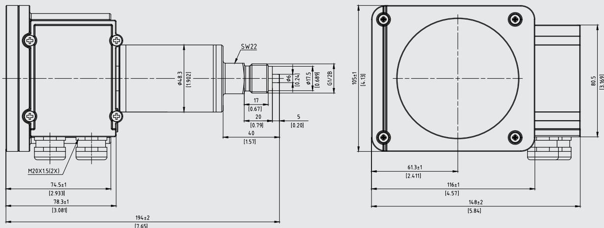
Modello GDM-RC-100-T con trasmettitore integrato e attacco al processo verticale G ½ B
