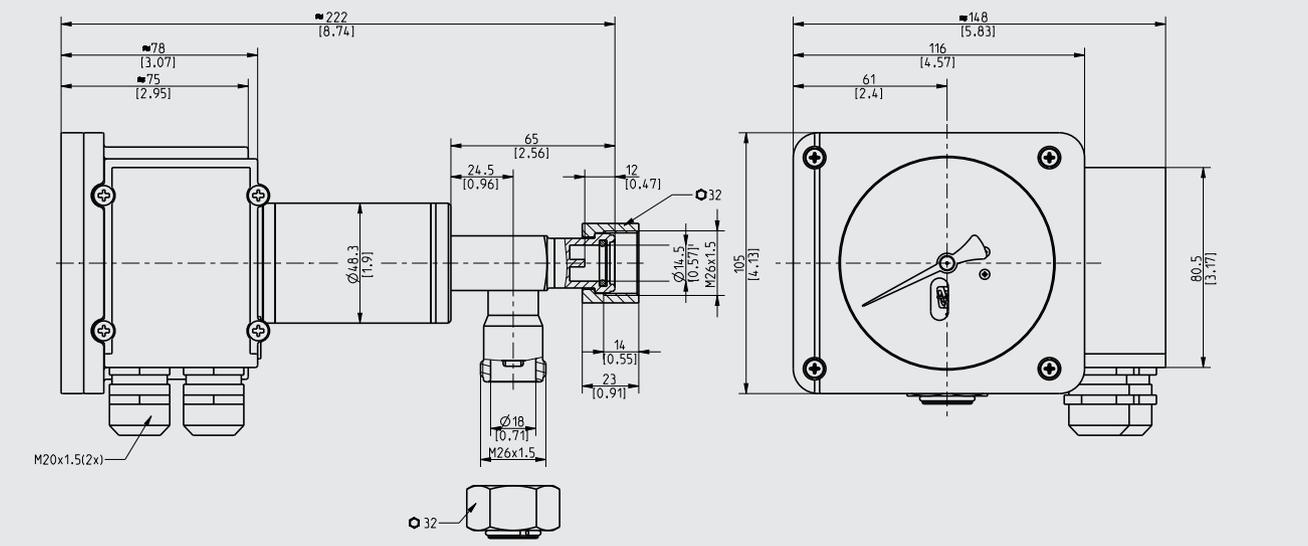
**Modello GDM-RC-100-T con trasmettitore digitale collegato e attacco al processo verticale G 1/2 B e valvola di ritaratura**
