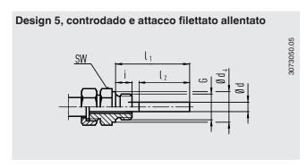
Profondità di immersione  $I_1$  = variabile Lunghezza  $L = I_1 + 40$  mm Acciaio inox 1.4571
