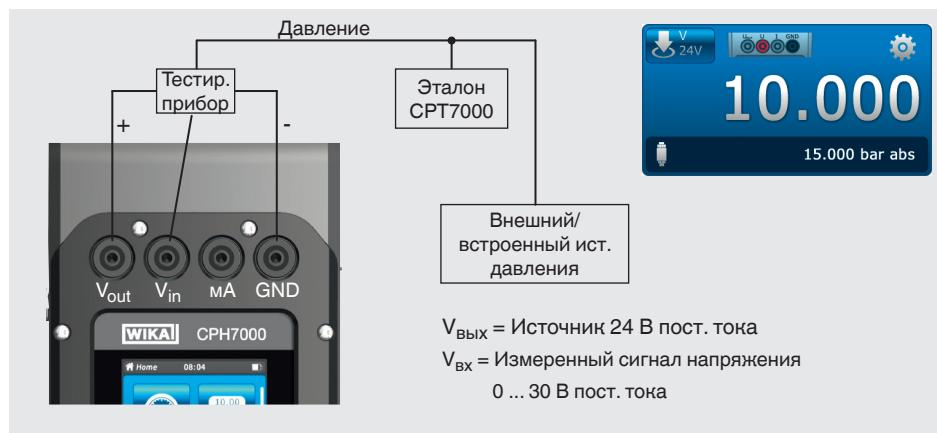
Для измерения напряжения необходимо загрузить приложение [Measure] и выбрать функцию “INV24V” (в одном из 3 окон).
