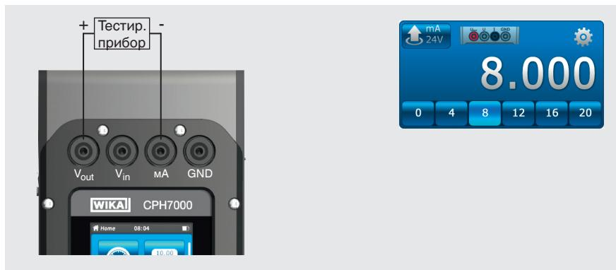
Для моделирования тока с помощью источника питания калибратора CPH7000 необходимо загрузить приложение [Measure] и выбрать функцию “OUTmA24V” (в одном из 3 окон).
