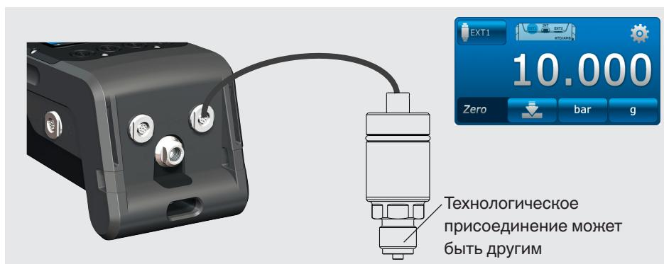
Схема соединений для канала 2
