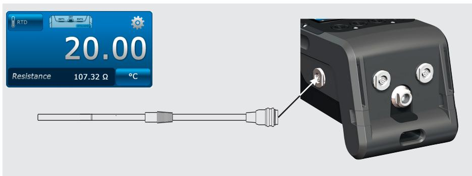
Разъем для подключения датчика Pt100 расположен в правой части корпуса CPH7000.
