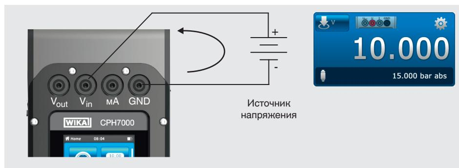
Для измерения напряжения необходимо загрузить приложение [Measure] и выбрать функцию “INV” (в одном из 3 окон).
